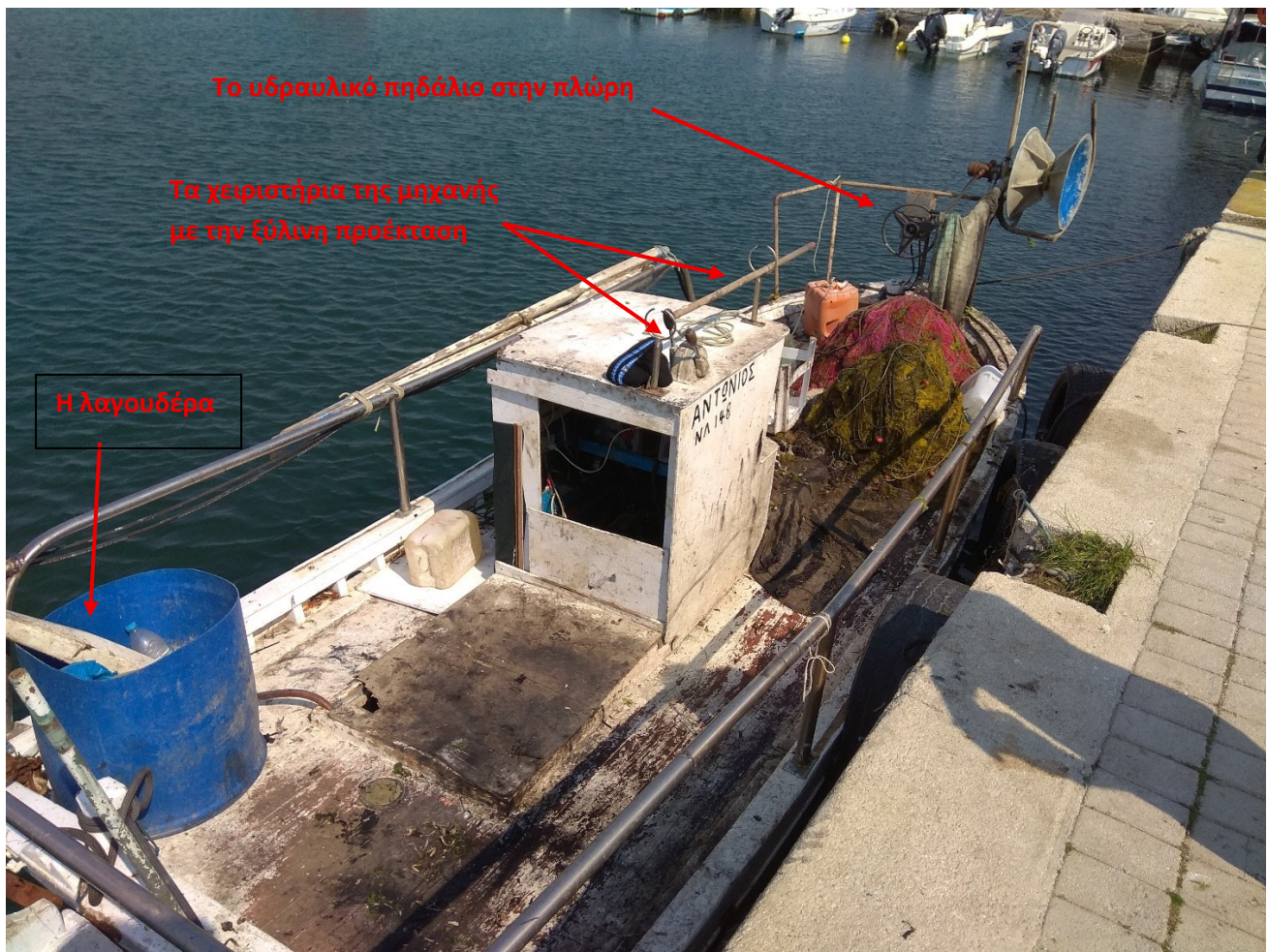
Εικόνα 3: Υποτύπωση των μέσων πηδαλιουχίας και χειρισμού της κύριας μηχανής
